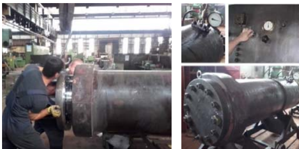
Slika 1. Karakteristike cilindra: a) geometrijske karakteristike, b) i c) detalji hidrostatičkog ispitivanja
